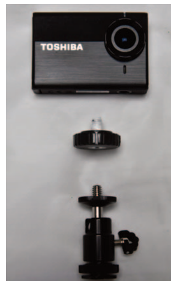
Montage d'une caméra-sport avec écrou de fixation sur un réflex.
