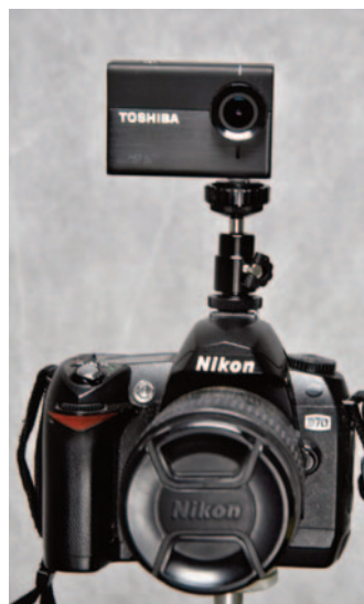
Montage d'une caméra-sport avec écrou de fixation sur un réflex.
