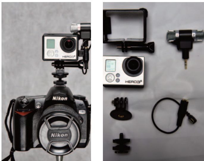
Détails des accessoires nécessaires pour monter une GoPro sur un réflex.
